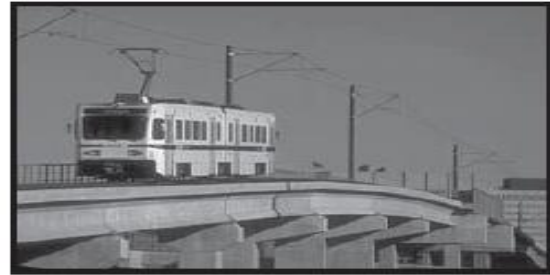
مسیر غیر هم‌سطح قطار سبک شهری، سن‌خوزه، آمریکا. به شیب تند پل در سمت راست توجه کنید
