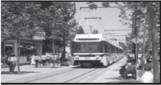
مسیر هم‌سطح قطار سبک شهری در یک پیاده‌راه، مجزا از سایر جریان‌های ترافیک، سن‌خوزه، آمریکا
